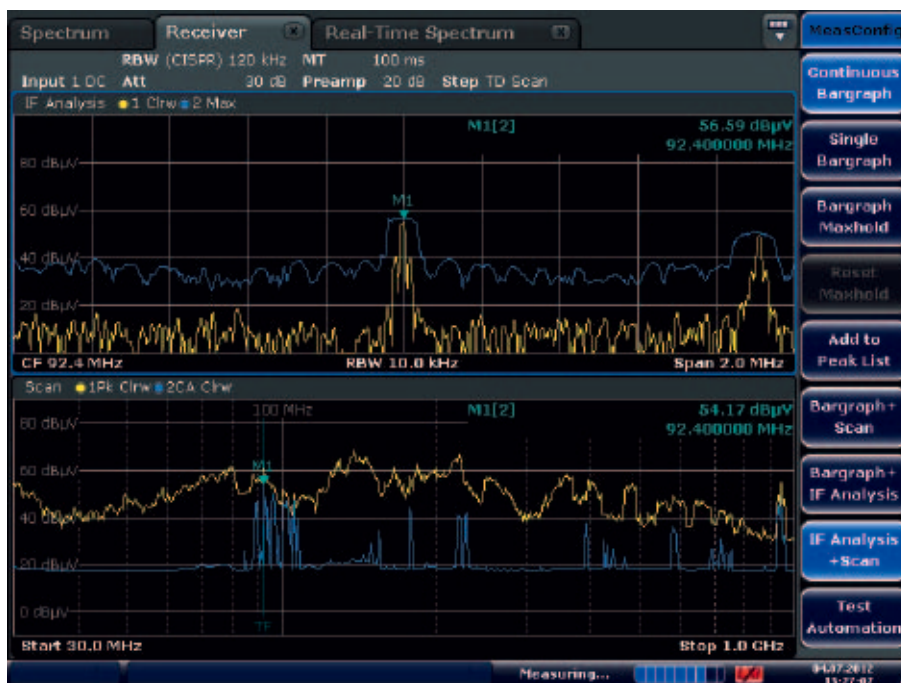
屏幕上方：使用中频分析功能，在当前EMI接收频率附近射频输入信号的连续频谱显示。 屏幕下方：预览测量的保存结果。上图中的中心频率由下图中的标记位置控制(标识跟踪功能)。或者，中频频谱显示的数值和柱状图三者可以连动。
