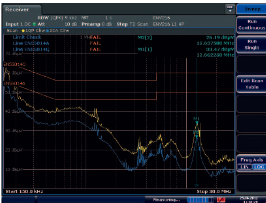
R&S®ESR执行具有准峰值和平均加权的骚扰电压测量仅需要几秒钟。
