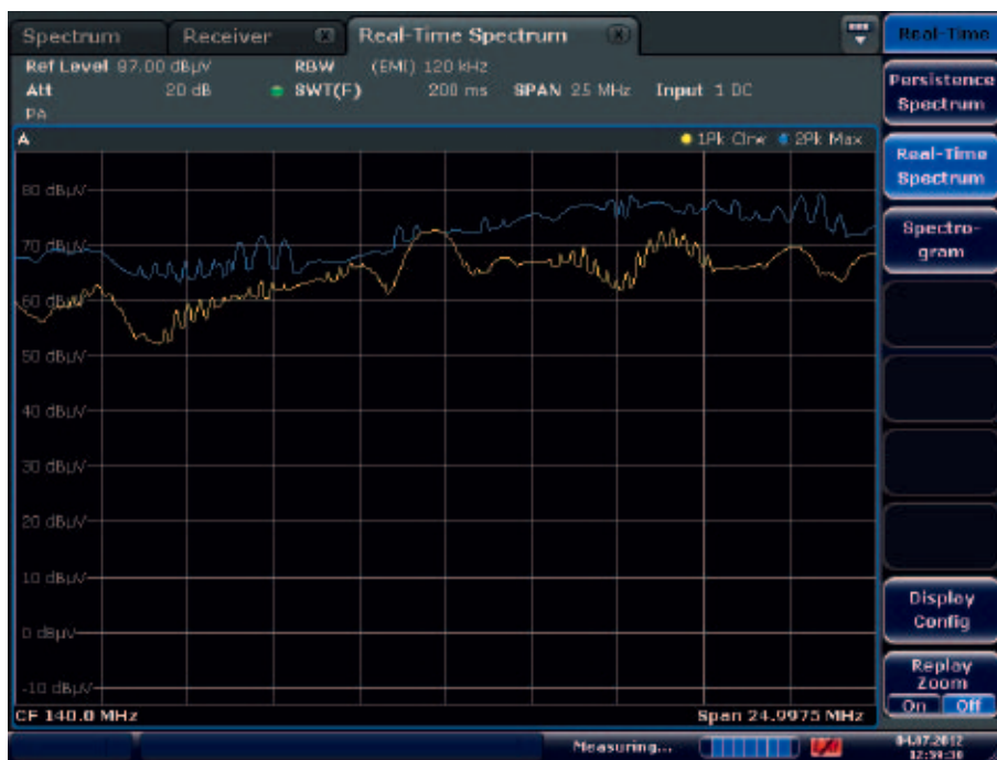
在常规分析仪模式中的宽带干扰 (本例中是由EMI抑制较差的电动机引起的) 显示。黄色轨迹代表当前的频谱，蓝色轨迹为最大值保持 (Max Hold)。
