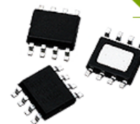
Package Type : SOIC-8
