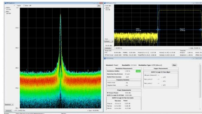
可以方便地进行完善的 WLAN 测量。在下面的 802.11g 信号显示上, 三维频谱图显示了初始导频序列, 后面是主信号突发。数据包的调制自动检测为 64 QAM, 显示为星座图。数据摘要显示 EVM 为 -33.24 db RMS, 突发功率测得 10.35 dBm。SignalVu-PC 选项适用于 40 GHz 带宽的 802.11a/b/j/g/p、802.11n 和 802.11ac。
