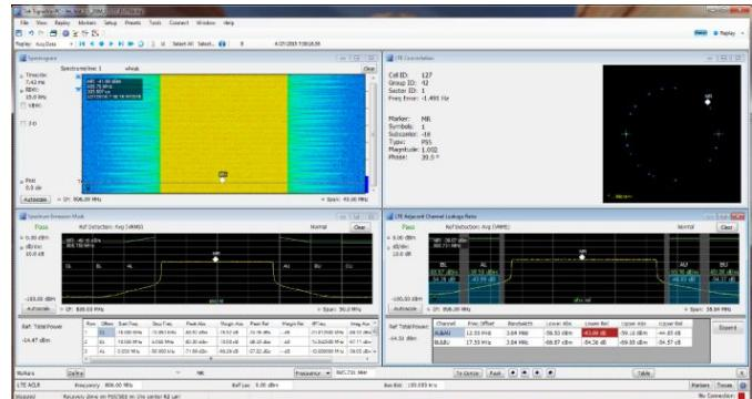
播放记录的信号可以把观看和等待频谱违规的时间从几小时缩短到几分钟，在桌面复核记录的数据。记录长度只受存储介质容量影响。SignalVu-PC 选项 SV56 播放可以全面分析所有 SignalVu-PC 测量，包括 DPX 三维频谱图。在播放过程中保持最短信号持续时间指标。可以执行 AM/FM 音频解调。提供可变频宽、解析带宽、分析长度和带宽。可以在记录的信号上执行频率模板测试，支持频宽最高 40 MHz，在模板违规时采取不同操作，包括发出蜂鸣声、停止采集、保存轨迹、保存图片、保存数据。可以选择和循环播放的部分，重复检查关心的信号。播放可以是无隙的，也可以插入时隙，缩短复核时间。实时速率播放保证 AM/FM 解调的保真度，提供 1:1 播放对实际时间。记录的时钟时间在三维频谱图标记中显示，关联真实世界事件。下图中正在播放 FM 频段，并使用模板检测频谱违规，同时在 92.3 MHz 中心频率侦听 FM 信号。
