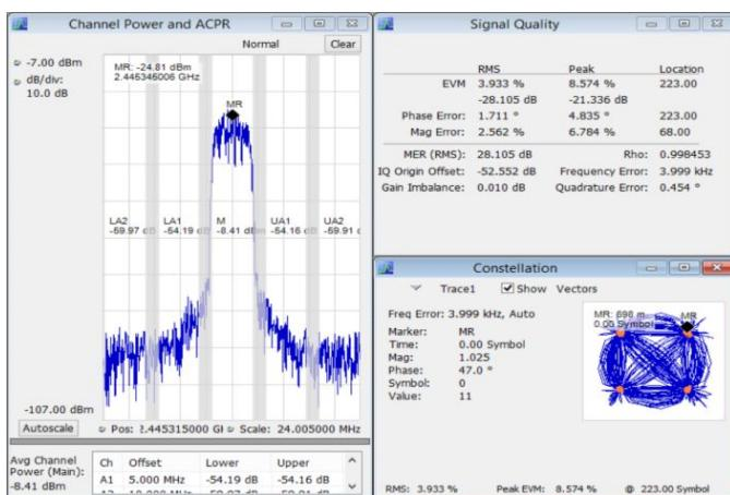
SignalVu-PC 选项 SV26 可以在 APCO P25 信号上快速进行基于标准的健康检查。下图显示了使用频谱分析仪监测第二期信号中的异常事件, 同时执行发射机功率、调制和频率测量。
