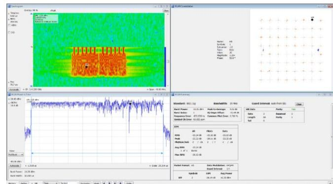
通过选项 SV27, 您可以在时域、频域和调制域中执行基于蓝牙 SIG 标准的发射机 RF 测量。这个选项支持蓝牙 SIG RF.TS.4.1.1 基本速率测试规范和 RF-PHY.TS.4.1.1 蓝牙低能耗测试规范规定的基本速率和低能耗发射机测量。选项 SV27 还自动检测增强数据速率包, 解调并提供符号信息。数据包字段在符号表格中采用彩色编码, 以清楚标识。
