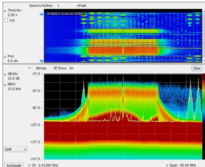
监测变得异常简便。频谱模板测试捕获频域中发现的瞬态信号细节, 如间歇性干扰。模板测试可以设置成停止采集、保存采集、保存图片、发送声音警报。下图显示了为监测一个频段违规而创建的频谱模板( 频谱画面上的橙色部分)。发生了一个持续时间为 125  $\mu$ s 的瞬态信号, 违反了模板, 违规用红色显示。在红色违规区域上方的三维频谱图( 圆圈) 中可以清楚地看到瞬态信号。
