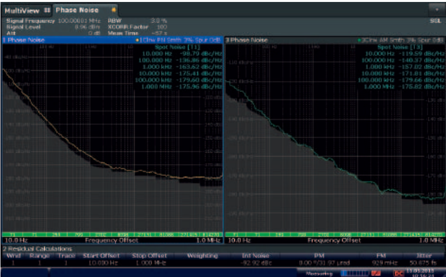
R&S®FSWP可同时测量相位噪声和调幅噪声。结果可显示在单独的窗口中，也可统一显示在一个窗口中。灰色区域显示R&S®FSWP的测量灵敏度。绿色迹线代表调幅噪声，黄色迹线代表相位噪声。
