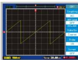
LAMP WAVE : 2V, 10KHz
