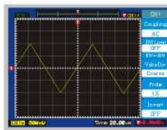
TRIANGLE WAVE : 2V, 10KHz
