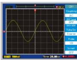
SINE WAVE : 2V, 10KHz
