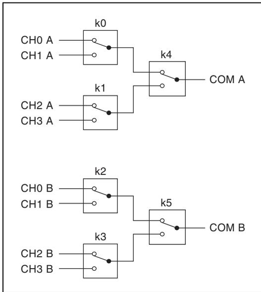
図 4 NI PXI-2546 電源投入時の状態
