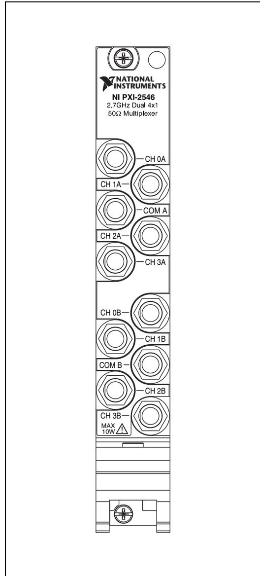
図 5 NI PXI-2546 フロントパネルコネクタ
