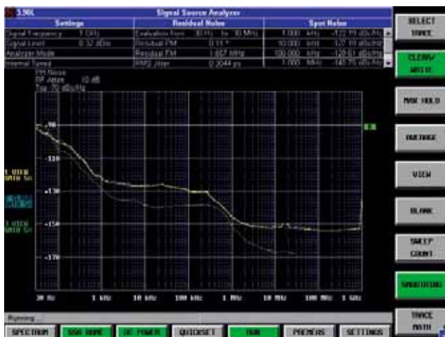
屏幕上显示了使用相位比较器和互相关方法进行的相位噪声测量（绿色轨迹）与使用频谱分析仪直接进行的测量（黄色轨迹）之间的比较。
