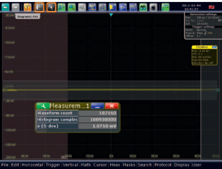
R&S®RTO1024示波器典型的固有噪声：直方图测量的标准偏差 (S-dev) 测量条件：50 mV/div，分辨率100ps，无滤波。
