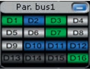
数字通道的信号状态在信号栏显示，与示波器捕获状态无关。
