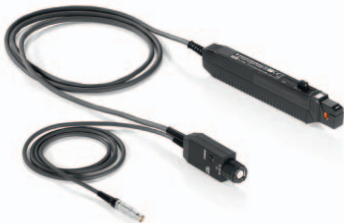
R&S®RT-ZC20电流探头 (100 MHz, 30 A (RMS))。
